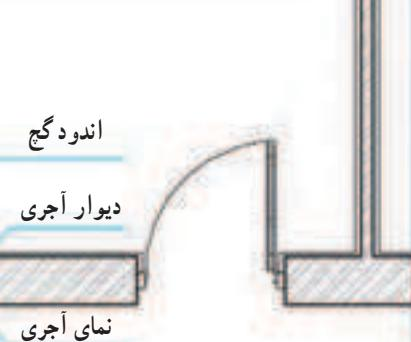
دیوار آجری با نمای آجری در خارج و اندود گچ در داخل به این شکل ترسیم می شود.
