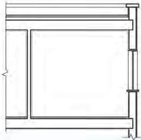
وقتی مقاطع در مقیاس  $\frac{1}{50}$  رسم می‌شوند می‌توانیم لایه‌های سقف و دیوار (مانند دیوارهای دوجداره) و عناصر نازک‌کاری و کفسازی را جدا از هم رسم نماییم.
