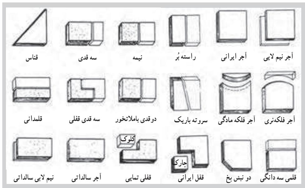
۶-۶- اجزاءی آجر و انواع تراش‌های روی آن
