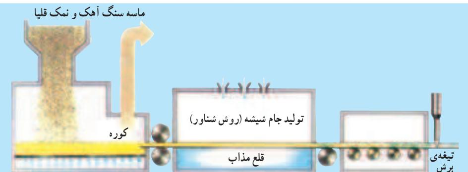
تصویر شماتیک کوره‌ی ذوب شیشه و تولید شیشه‌ی جام به روش قلع مذاب
