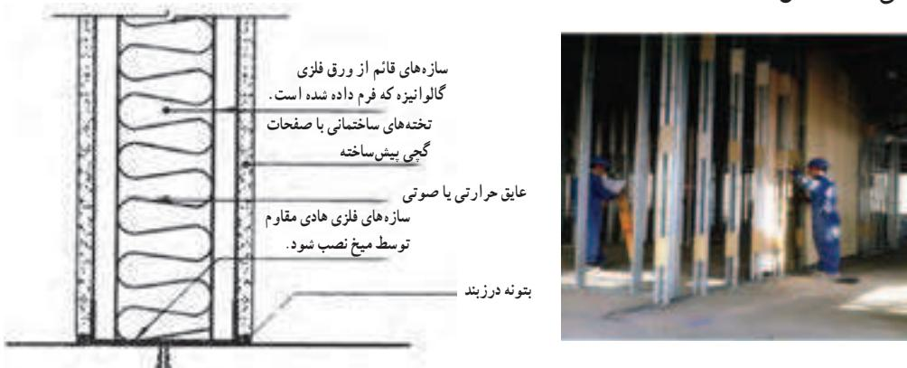
شکل ۱۵-۴—جزئیات دیوار مرکب با پوشش صفحات گچی و نحوه اجرای آن
