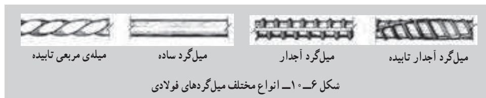
شکل ۱۰-۶— انواع مختلف میل‌گردهای فولادی
